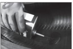
Utilize Ativador de superfície Bufpal para limpar a área a ser raspada. Não use ar comprimido para limpeza e secagem.
