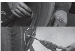
Introduza de dentro para fora a vareta de latão, o suficiente para atravessar a carcaça. Com o auxílio de um alicate puxe o reparo pela haste até o final. Esta ação provocará um alongamento e por consequência um afinamento momentâneo da haste, facilitando a sua introdução.
