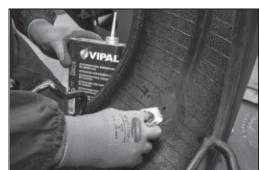
Utilize Ativador de superfície Bufpal para limpar a área raspada. Não use ar comprimido para limpeza e secagem.
