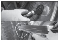
No lado interno, rolete o disco do MC, do centro para as laterais e aplique selante nas bordas. Do lado externo, corte sem tracionar a haste, pouco acima da banda de rodagem. O prenó estará pronto para ser montado, inspecionado e colocado em uso.
