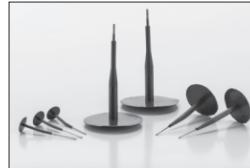
Composto por um disco e uma haste que cumprem a dupla função de vedar e preencher o dano. Os reparos MC (Manchão Conjugado) são indicados para reparar danos de 3, 6, 8 e 10 mm, em pneus radiais, na banda de rodagem.
